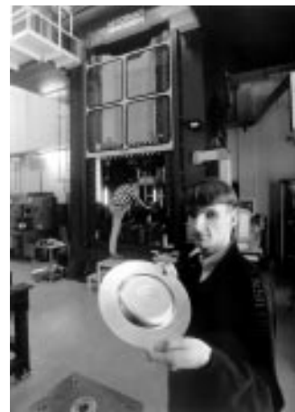
Die Spezialität der neuen Presse: Das Innenhochdruckumformen von Formteilen aus Blechen. Foto: Fuchs
