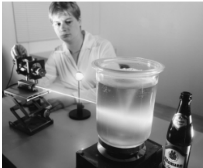
Mit dem Laser In-Situ Analysesystem LISA kontrolliert die Lebensmittelchemikerin Sonja Engelhard vom Lehrstuhl Physikalische und Theoretische Chemie die Klarheit des Bieres. Foto: Fuchs
